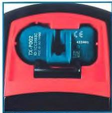
Sensor in Programmierereinheit einsetzen
