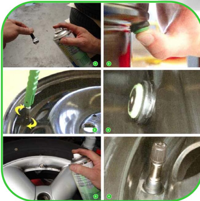
*Ventilloch reinigen und auf Beschädigungen prüfen !*
